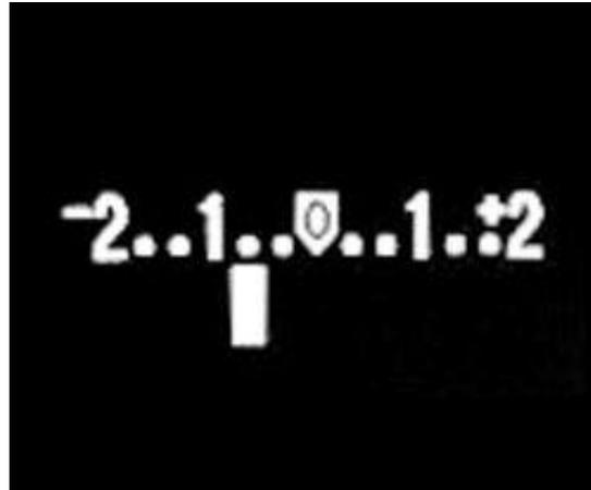
Figura 41 -Fotômetro marcando quantidade de luz ideal, e fotômetro indicando luminosidade insuficiente, respectivamente.
