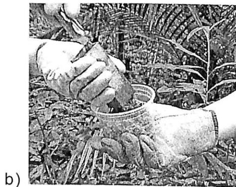
Figura 5. Sonda metálica utilizada para a coleta de material (solo/liteira) das subamostras. a) sonda introduzida no solo; b) colocação do material coletado com sonda no recipiente coletor para formar uma subamostra.
