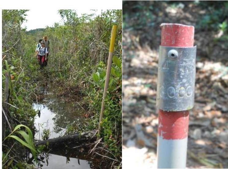
**Figura 2.** Exemplo de uma trilha demarcada com piquetes. O piquete possui uma placa de metal que informa o nome da trilha e a posição em metros (3.000 m, no exemplo). Fotos: Julio do Vale.
