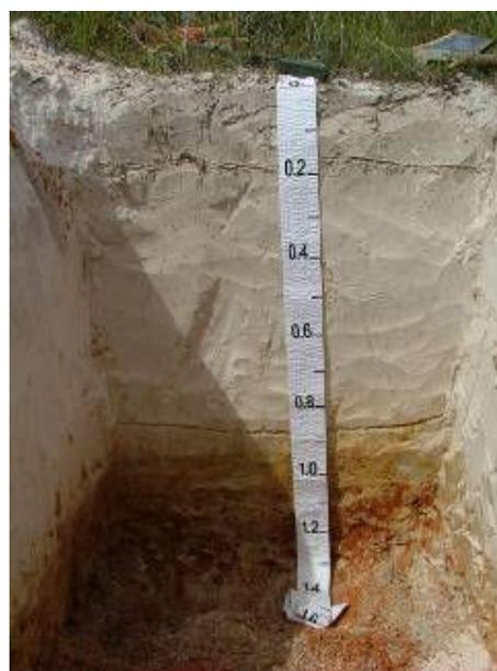
Figura 10: Métodos utilizados no inventário de solos do Parque Nacional do Viruá: escavação de trincheira para caracterização e coleta de horizontes dos solos; utilização da Carta de Munsell para determinação das cores dos horizontes descritos.
