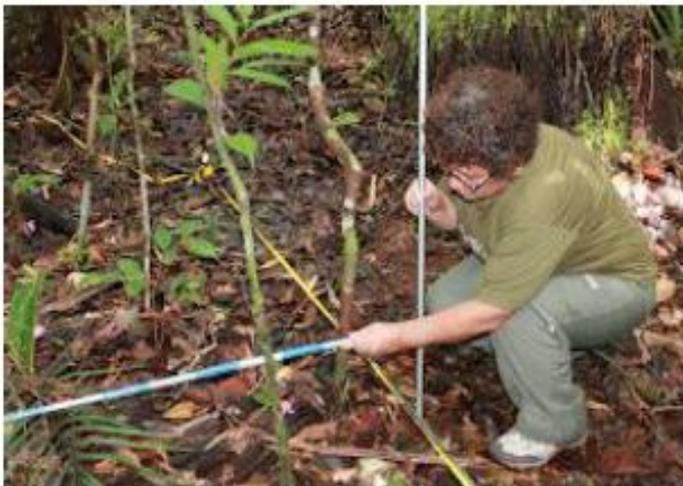
Figura 8 – A foto mostra como são feitas as medidas das coordenadas x e y. Uma vara de alumínio é posicionada sobre a trena mostrando o valor de medida do eixo X, enquanto que com outra vara graduada se faz a medida da coordenada Y. (foto Fê Coelho).
