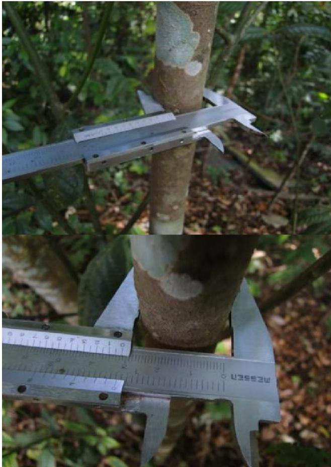
Figura 14. Medida diamétrica utilizando paquímetro em plantas com DAP  $\leq$  5 cm de diâmetro.
