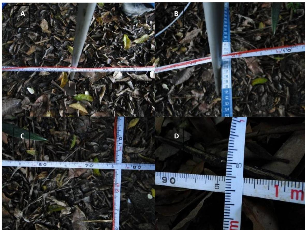
Figura 11 – As fotos mostram a posição da vara auxiliar para medida da coordenada X (A) e da coordenada Y com vara graduada (B) e com a trena (C) e a posição de  $90^{\circ}$  entre as duas trenas (D). (fotos MA Freitas).
