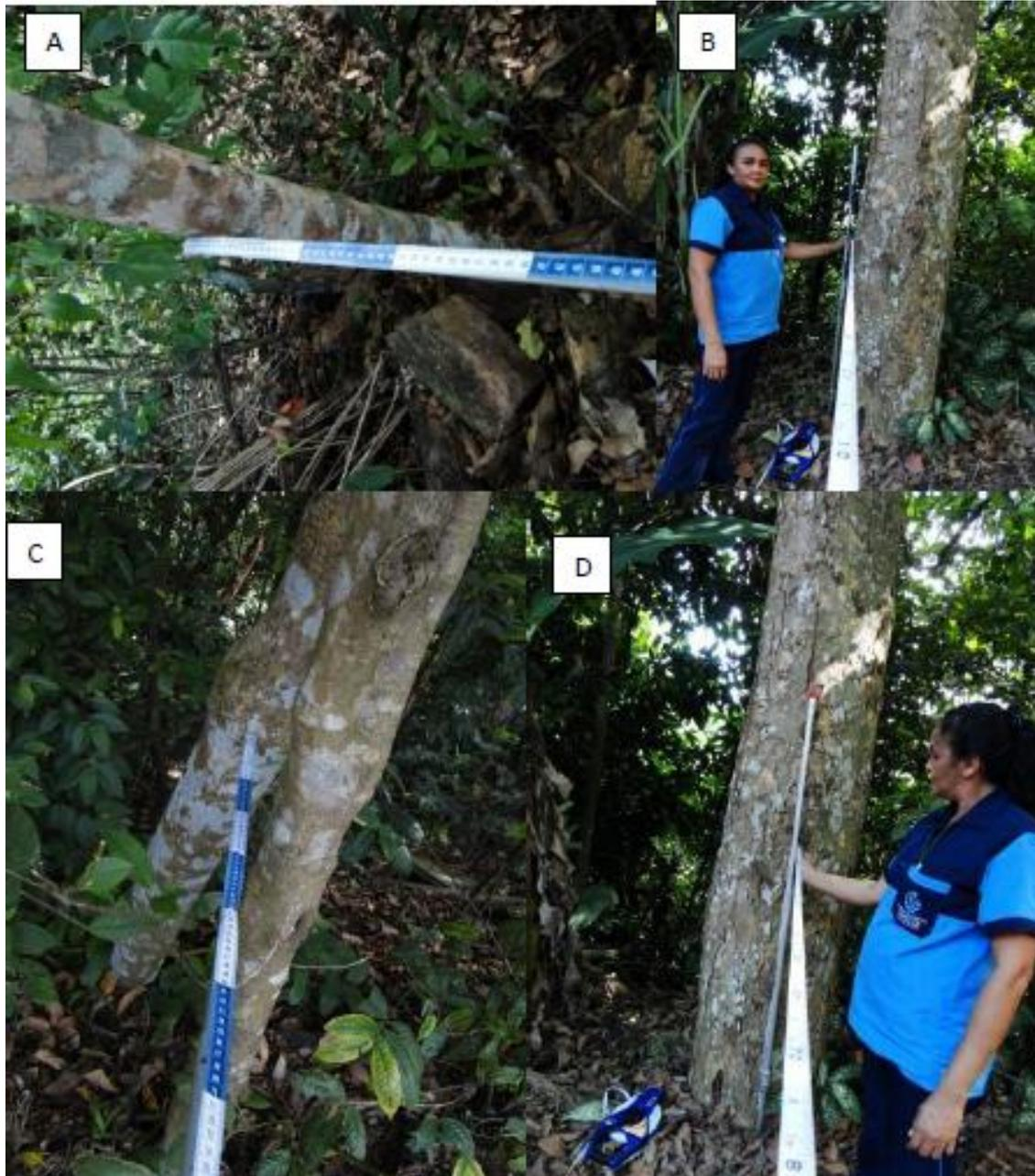
Figura 10 – A foto mostra a posição em que a vara graduada deverá ficar para tomar as medidas das coordenadas Y (A) e X (C) e da trena para as coordenadas Y (B) e X (D). (foto MA Freitas).
