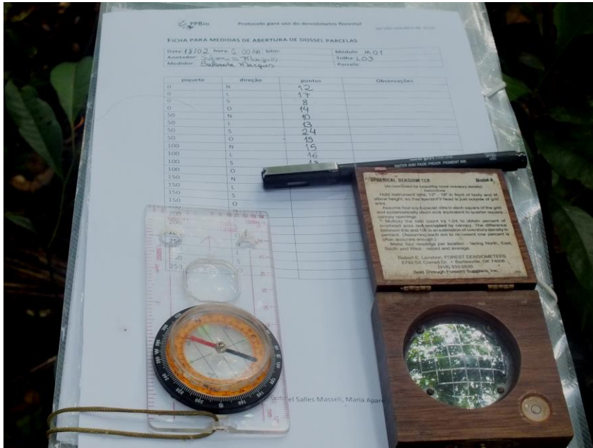
Figura 3: Ficha para medidas de abertura de dossel parcelas prancheta, lápis 2B, borracha, sacos plásticos para a prancheta, bússola, esferodensiómetro metadados e dados de azimute do Sítio. Foto: Sulamita Marques.
