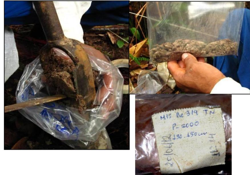
Figura 7 – procure colocar cerca de 200gs de solo diretamente no saco, retire o excesso de ar do saco e coloque a etiqueta com as informações pertinente a esta coleta. Fotos PPBio
