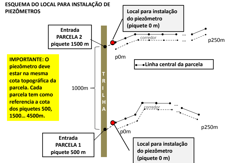
Figura 1. Representação esquemática dos locais onde deve ocorrer a coleta de solos deformados durante a instalação dos piezômetros. (Thaise Emilio).
