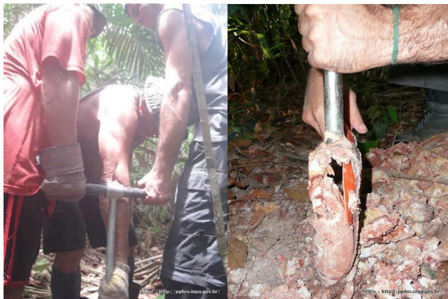
Figura 6 – coleta de solo. A) retire o trado perpendicularmente ao solo e com o auxílio de uma espátula retire o solo. Fotos PPBio
