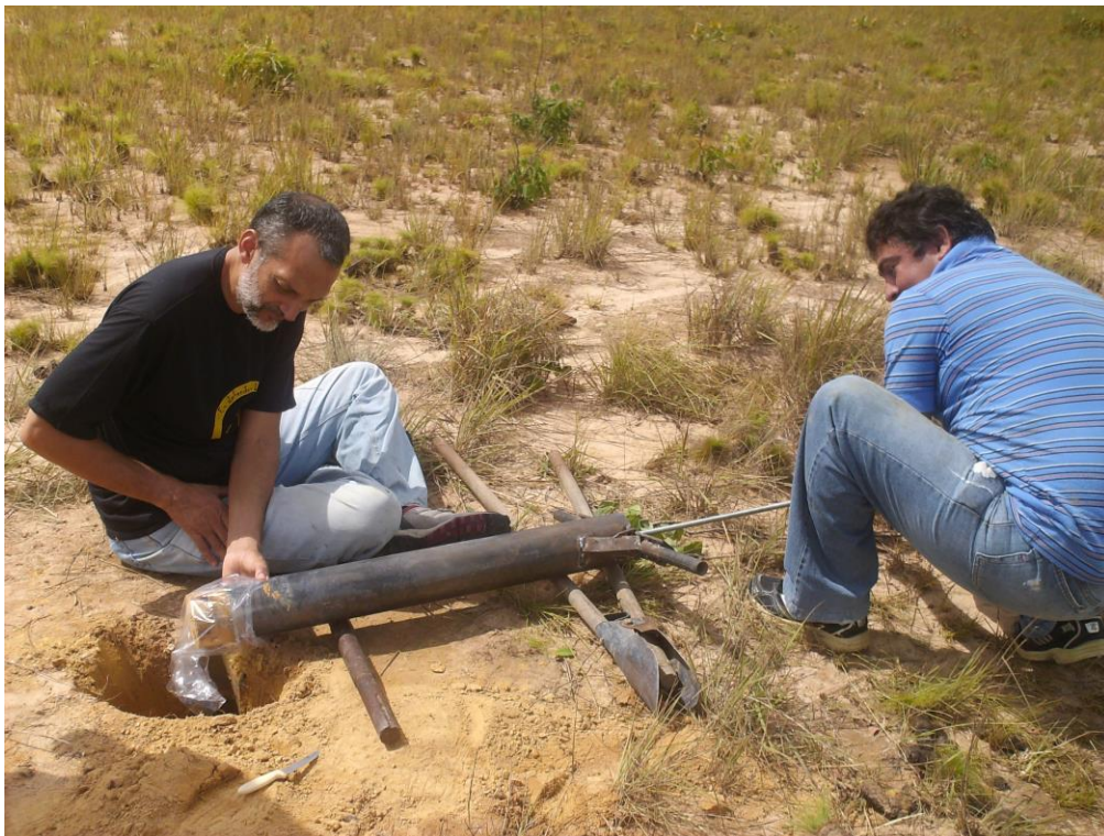
Figura 6 – Uso da haste metálica para auxiliar a retirada de cada seção do perfil vertical do solo. Extração das seções deve ser realizada em campo.
