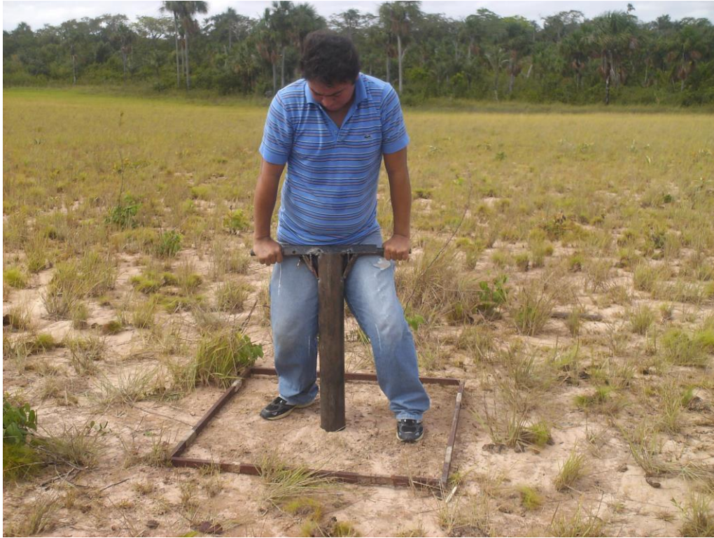
Figura 5 – Introdução do coletor no solo para início do processo de amostragem da biomassa de raízes (notar que a biomassa herbácea já foi coletada).
