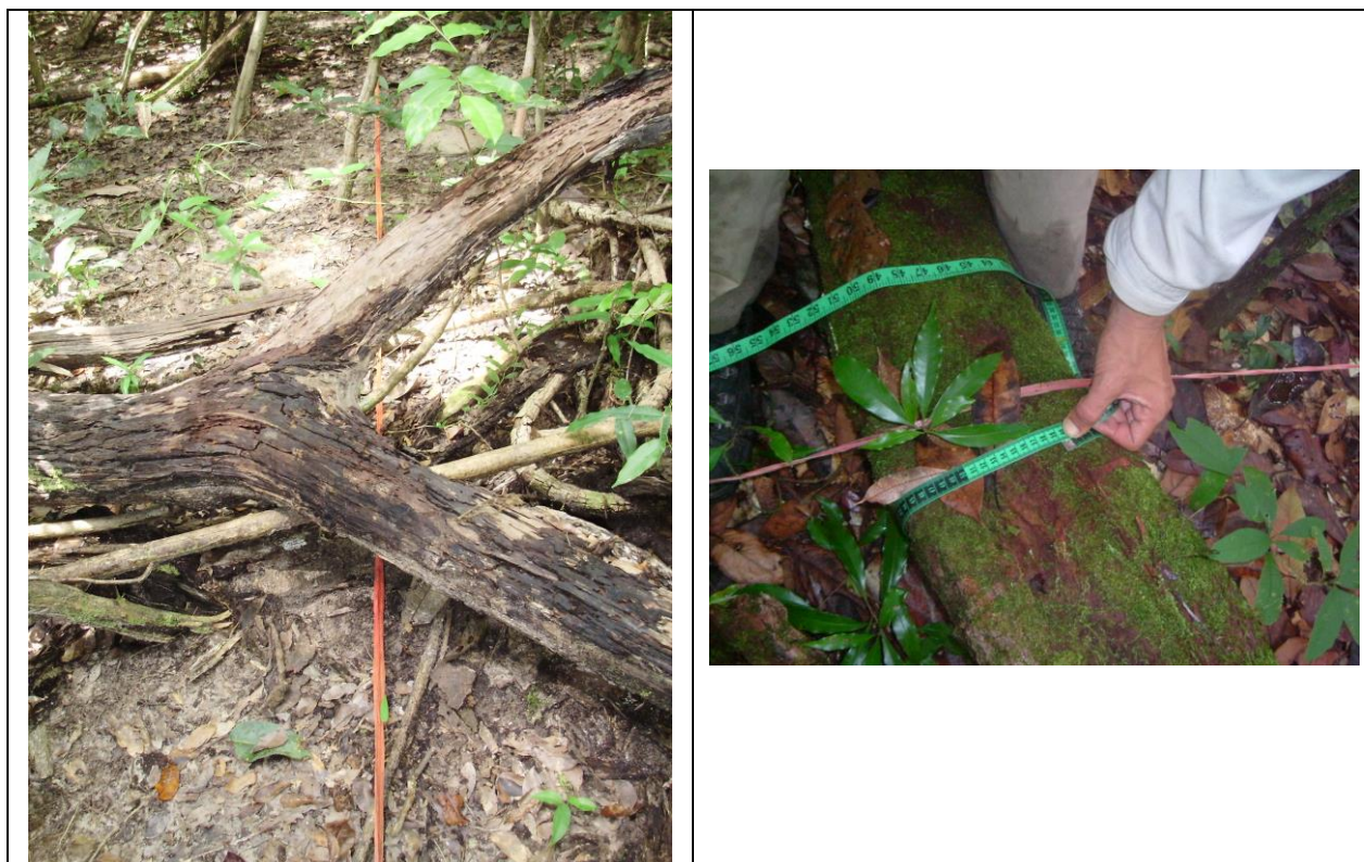
Figura 3 – (A) transecto do método LIS instalado nas parcelas permanentes para obtenção do volume de necromassa de liteira grossa (linha vermelha representa a linha de base central do transecto) e (B) medida do diâmetro ou circunferência) de uma peça de madeira morta.
