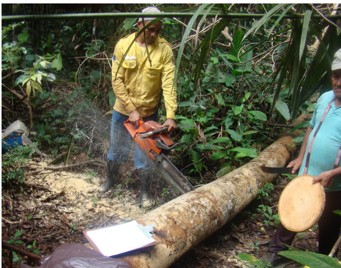
Figura 2 – Retirada do disco amostral (testemunho) para estimar os espaços vazios (% perda de massa física) e a densidade da madeira ( g\ cm^{-3} ) de cada peça individualmente.
