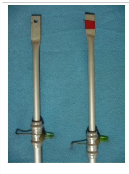
Figura 1. Varas de alumínio com níveis e ajuste utilizados para encaixar o clinômetro e para Alinhar a medição da inclinação.
