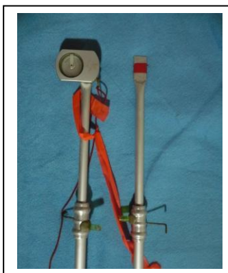
Figura 1: Exemplo de vara para suporte do clinômetro e da vara alvo (pintada de vermelho na ponta).
