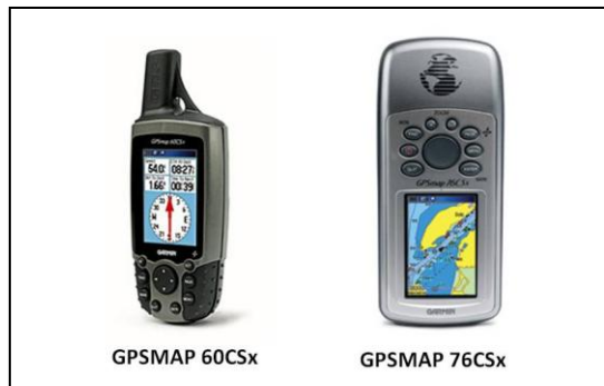
Figura 1. Modelos de GPS da Garmin adequados para medições sob floresta densa. Os dois modelos possuem barômetro (que precisa ser calibrado) e são à prova d'água, mas somente o 76CSx flutua na água.
