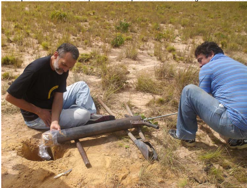
Figura 4 – Introdução do coletor no solo para início do processo de amostragem da biomassa de raízes.
