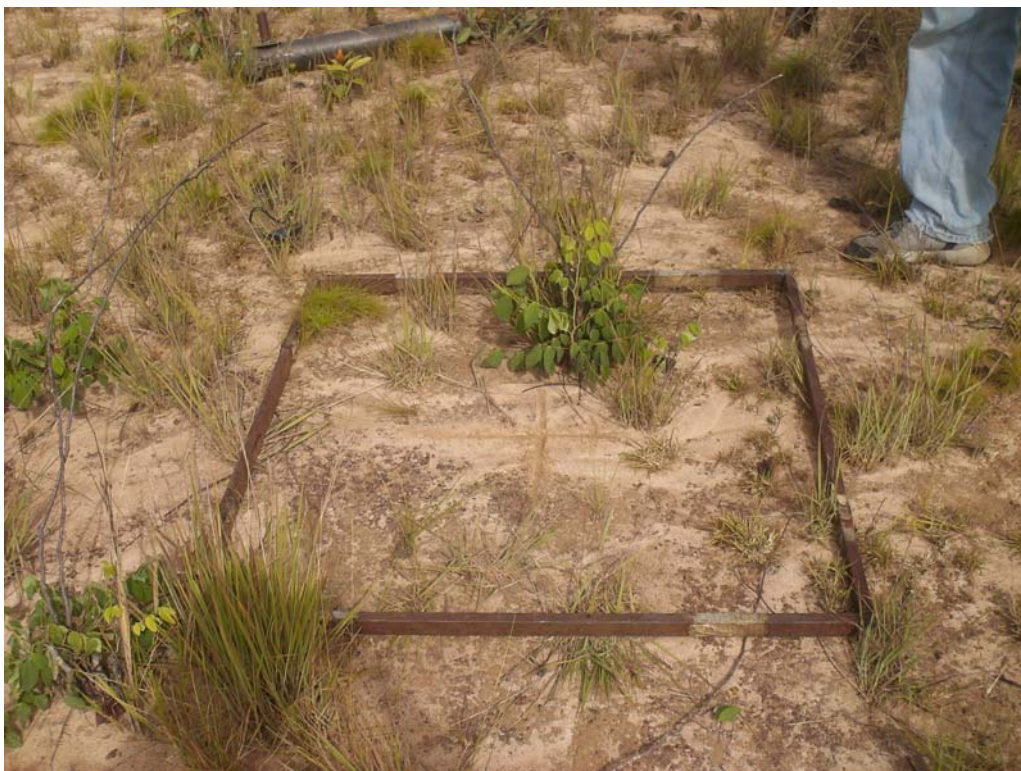
Figura 3b – Exemplo do estabelecimento do gabarito com o indicativo do local da coleta de solo ao centro do mesmo.
