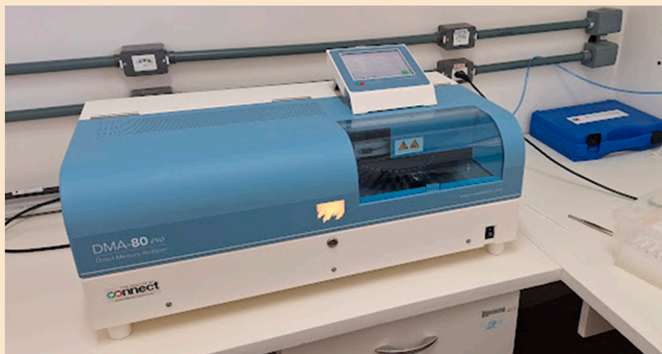
DMA-80 evo III utilizado na determinação de mercúrio. Foto por Angelo Gilberto Manzatto.
