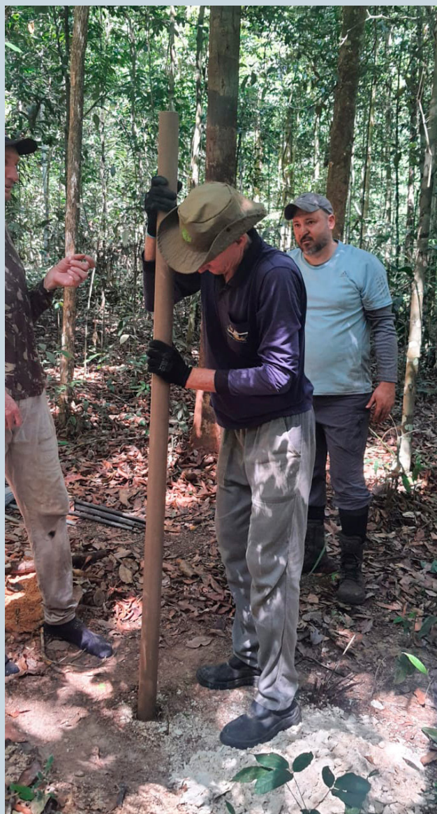
Processo de escavação para instalação de medidores de lençol freático em módulo do estado do Mato Grosso.
