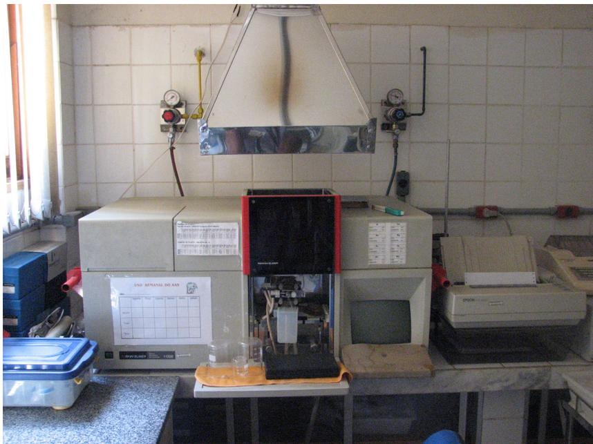
Figura 8: Espectrofotômetro de absorção atômica do laboratório de solos do Instituto Nacional de Pesquisas da Amazônia - INPA.
