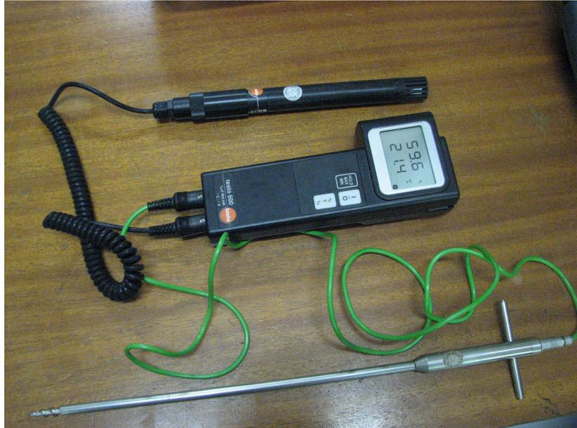
Figura 7: — Termohigrômetro. Instrumento de medição de umidade e temperatura.
