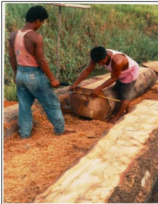
Figura 2. Cubagem e desdobro da madeira para construção comunitária na RDS Mamirauá. Fonte: Acervo Institucional IDSM, 2025.
