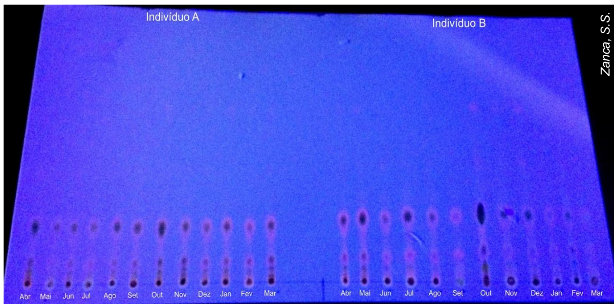
Figura 15 – Cromatografia em Camada Delgada Comparativa de extratos metanólicos de folhas de dois indivíduos de Duroia macrophylla , coletados de abril/2013 a março/2014, com revelação sob luz ultravioleta em 365 nm, sistema de eluição DCM puro.
