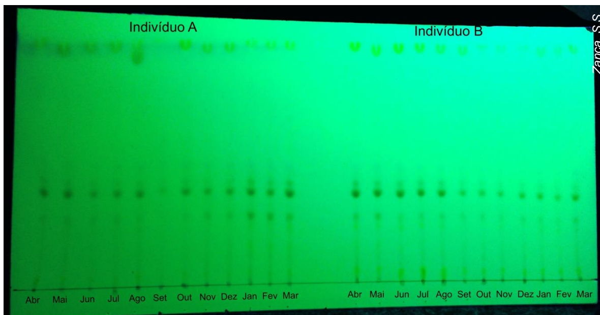
Figura 09 – Cromatografia em Camada Delgada Comparativa de extratos hexânicos de folhas de dois indivíduos de Duroia macrophylla , coletados de abril/2013 a março/2014, com revelação sob luz ultravioleta em 254 nm, sistema de eluição Hexano/Acetato de Etila 8:2.
