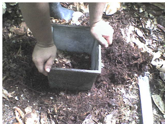
Figura 5 – Pressão da sonda contra o solo.
