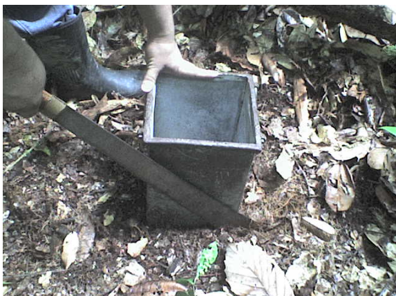
Figura 4- Corte das raízes com facão e sonda.
