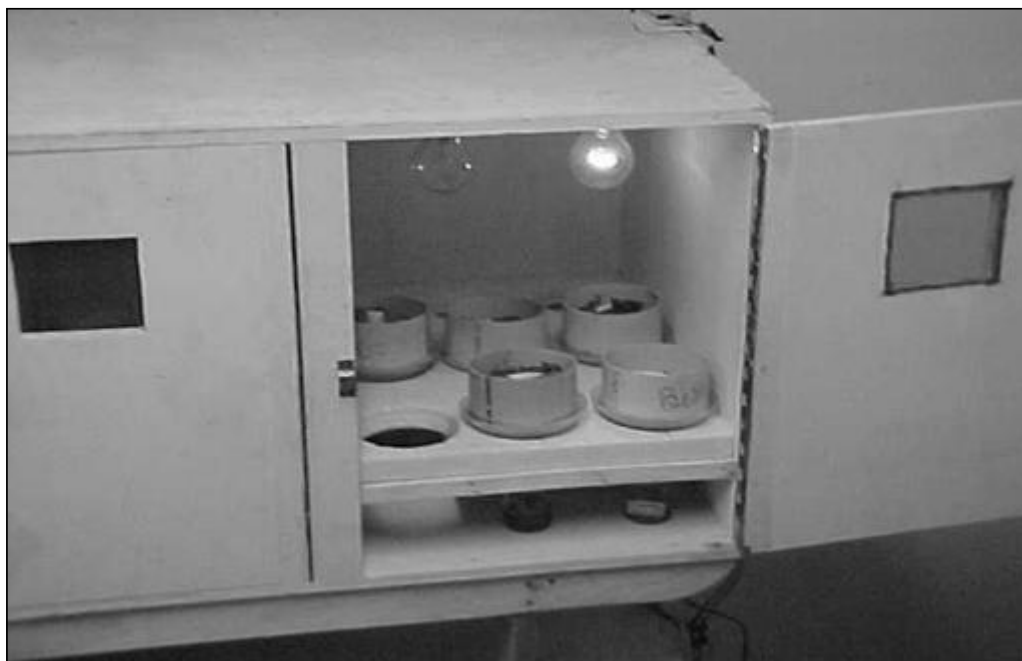
Figura 4. Aparelho de Berlese-Tüllgren modificado por Franklin & Morais, 2006 utilizado para extração dos ácaros oribatídeos das sub-amostras de solo. Foto Elizabeth Franklin.
