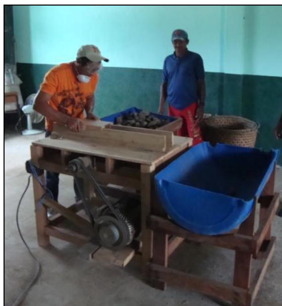
Figura 21 – Máquina produzida pelos próprios cooperados para facilitar o processo de produção da COOPFITOS. Com esta eles podem quebrar o babaçu e o tucumã,
