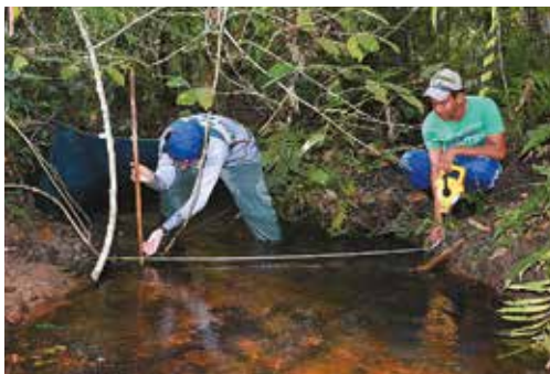
Figura 1. Amostragem dos parâmetros estruturais do riacho, largura, profundidade e determinação do tipo de substrato do leito do riacho Sr. Ângelo.
