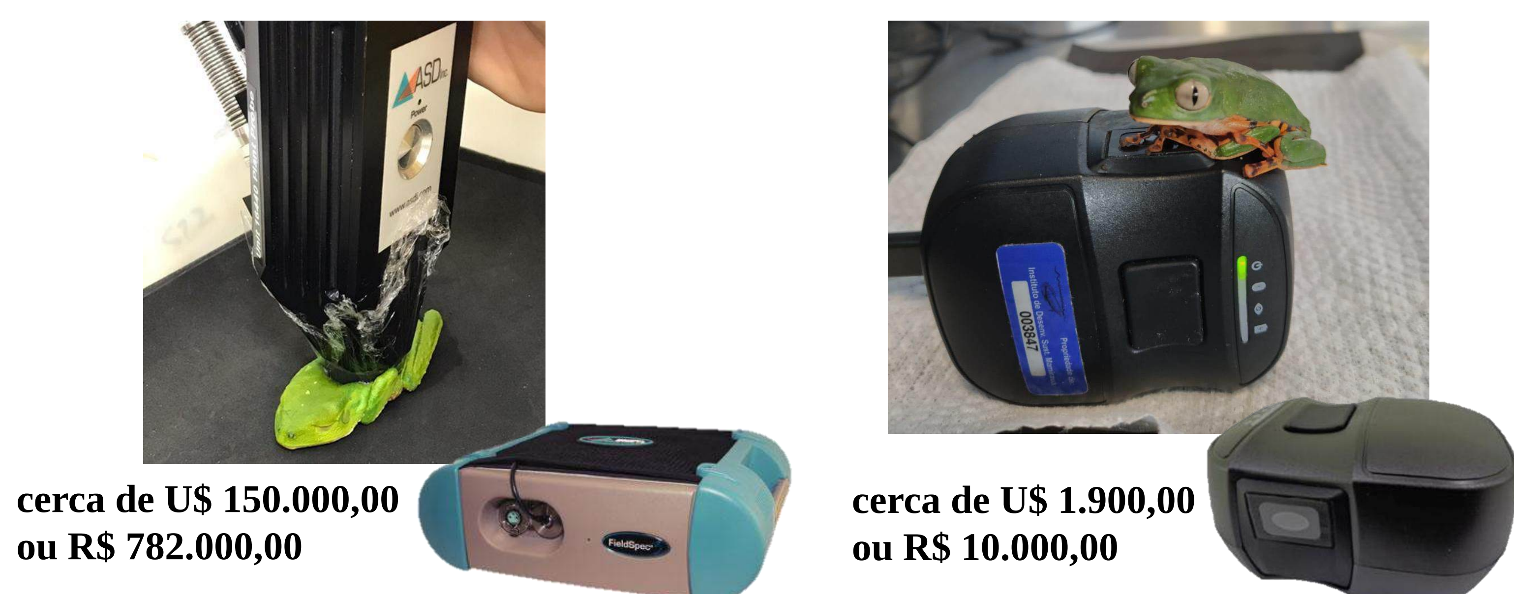
FIGURA 1: Equipamentos portáteis de espectroscopia NIR e seus valores de custo em dólar e reais.
