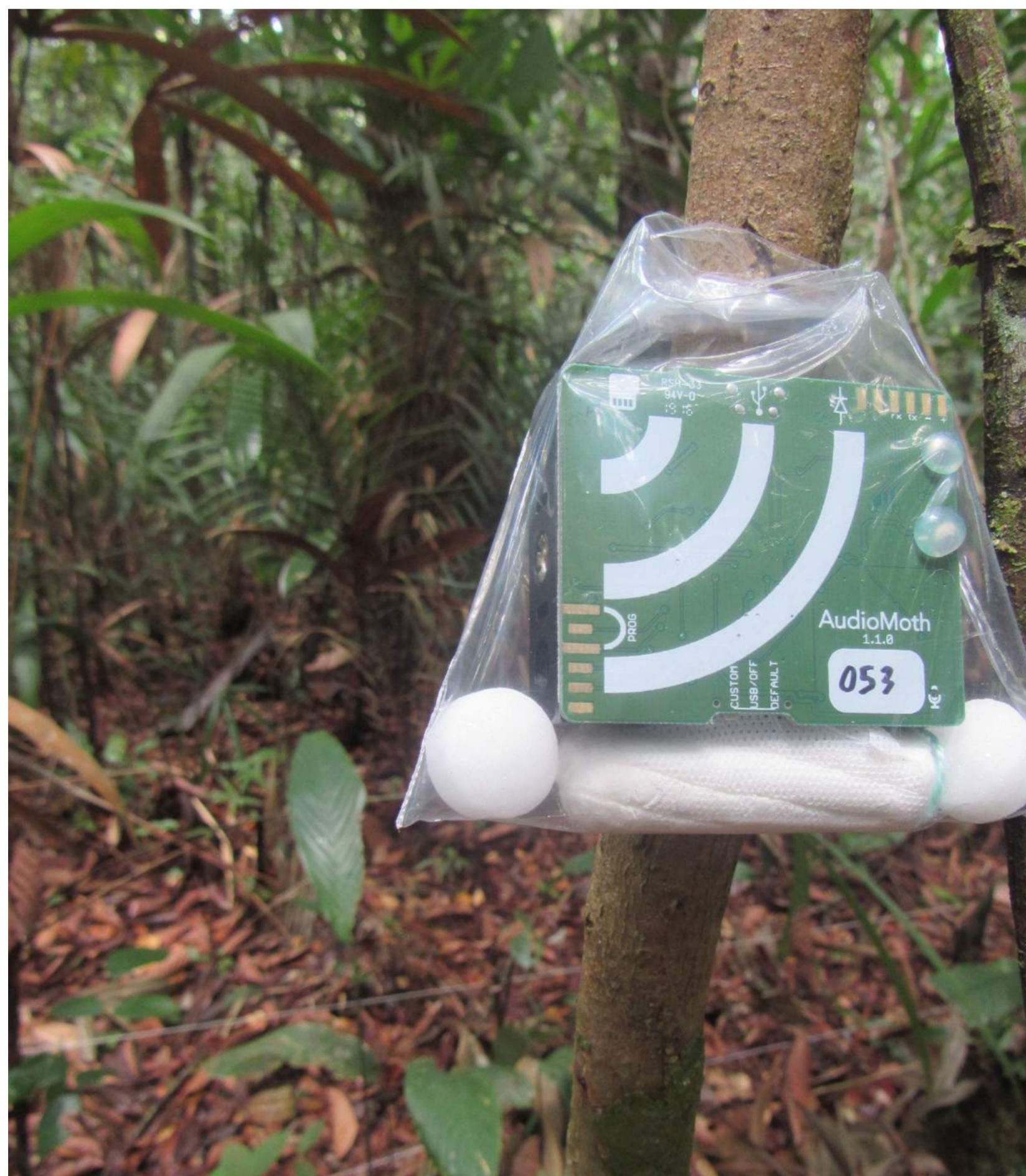
Gravador autônomo disposto em uma das parcelas.
