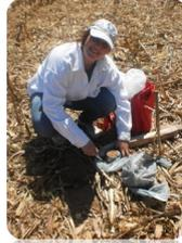
Figura 2. Retirada da amostra de solo por meio de um cilindro metálico.
