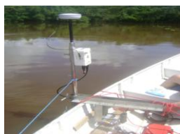
Fig. 02 ADP M9 – Aparelho usado para medição de vazão
