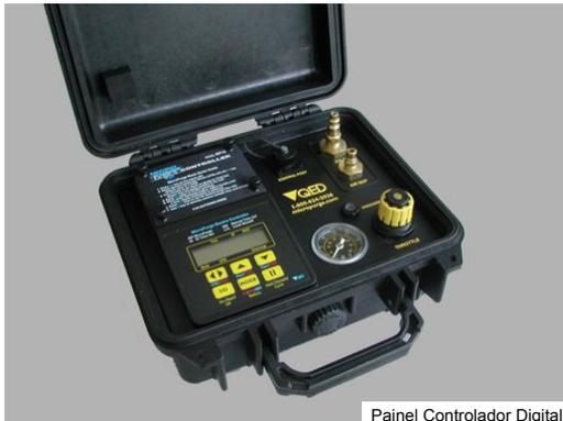
Painel Controlador Digital MP10 para amostrar Baixa-Vazão
