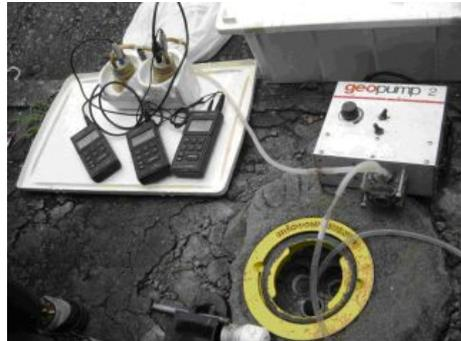
Sistema de amostragem *low flow* caseiro (com células de fluxo)
