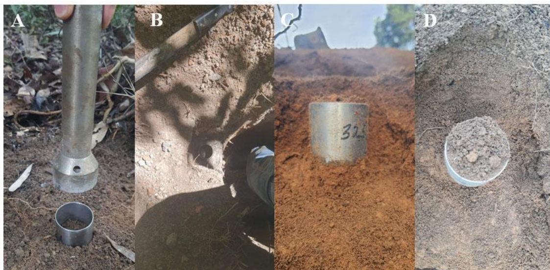
Figura 6 - Procedimento de coleta para avaliar a densidade do solo. Introdução (A), ampliação da abertura (B) e limpeza ao redor (C) e acima do cilindro (D).
