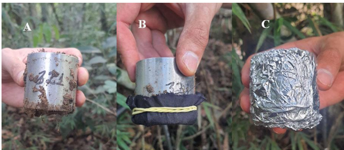
Figura 7 - Limpeza do cilindro (A), colocação do suporte para manter o solo intacto dentro do cilindro (B) e conservação das amostras em papel alumínio (C).
