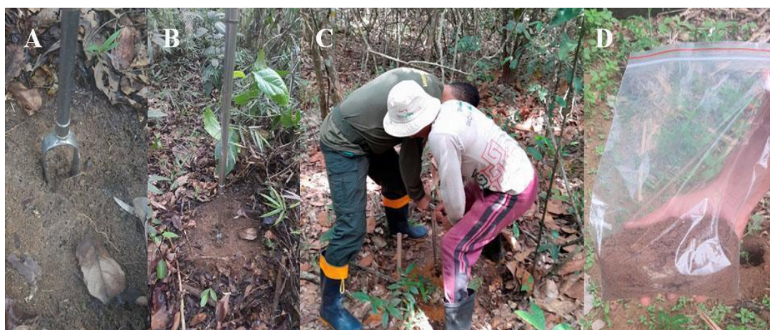
Figura 2 - A) Remoção da serrapilheira, B) introdução do trado holandês no solo, C) retirada da amostra, e D) acondicionamento em saco plástico.
