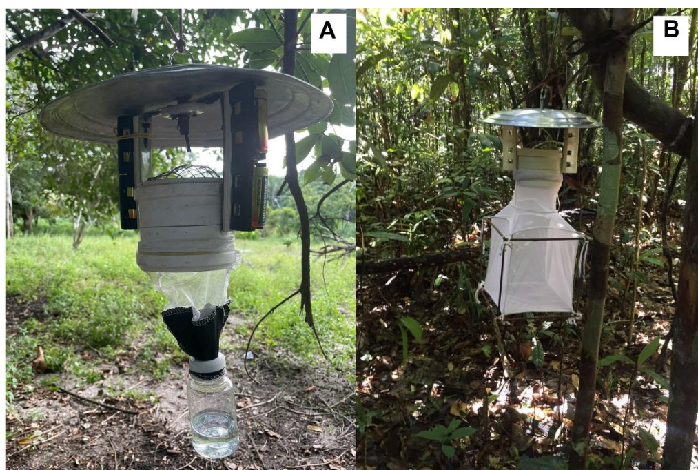
Figura 1 - Exemplos de armadilhas CDC instaladas em campo com (A) frasco coletor contendo álcool 100% para captura de Ceratopogonidae, Psychodidae e Simuliidae e, (B) saco de malha fina para captura de todos os vetores incluindo Culicidae.
