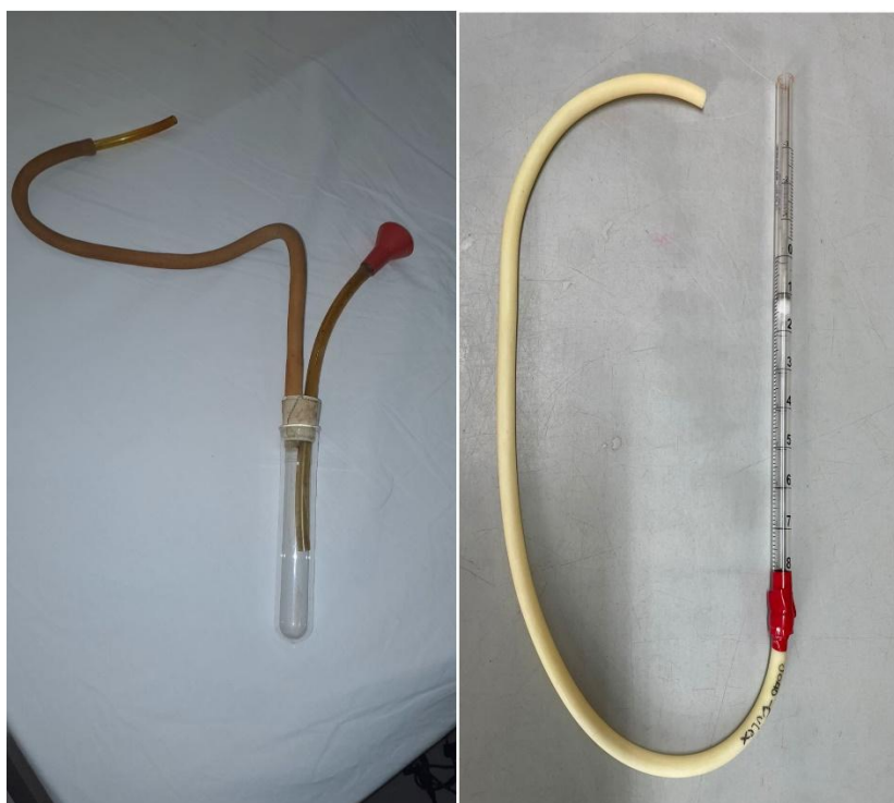
Figura 2 - Dois exemplos de aspiradores entomológicos a serem usados para captura de espécimes de culicídeos vivos no saco de malha dos CDCs. No exemplar a esquerda, há um frasco onde os culicídeos são retidos e mantidos até serem transferidos para a manta, envelope entomológico, para o RNAlater ou para o nitrogênio líquido, a depender do objetivo. No exemplar à esquerda, os culicídeos são retirados individualmente e colocados no preservante.
