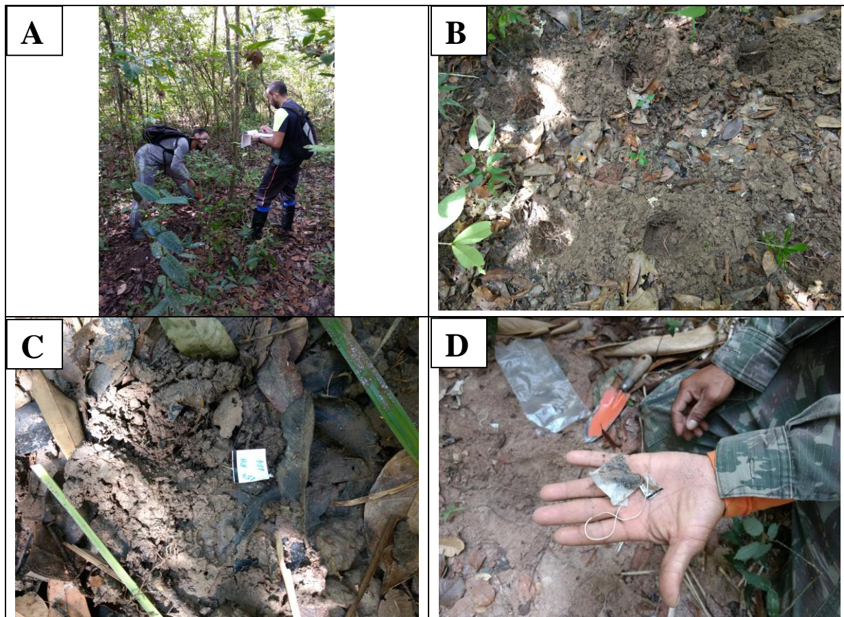
Figura 2 - Procedimentos de campo para instalação e coleta dos tea bag: (A) identificação da parcela e dos piquetes de instalação do experimento, (B) abertura das covas (8 cm de profundidade), (C) enterramento das unidades mantendo as etiquetas acima do solo, (D) unidade desenterrada, preservada em sacos plásticos para posterior avaliação da integridade física, limpeza de detritos, secagem e pesagem.
