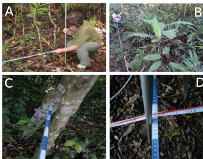
Figura 4 - Recomendações para obtenção das medidas das coordenadas X e Y (A, B, C e D). Uma vara de alumínio graduada é posicionada sobre a trena mostrando o valor de medida do eixo X, enquanto com outra vara graduada se faz a medida da coordenada Y (A). Fotos: Fernanda Coelho e Adeilza Felipe Sampaio.
