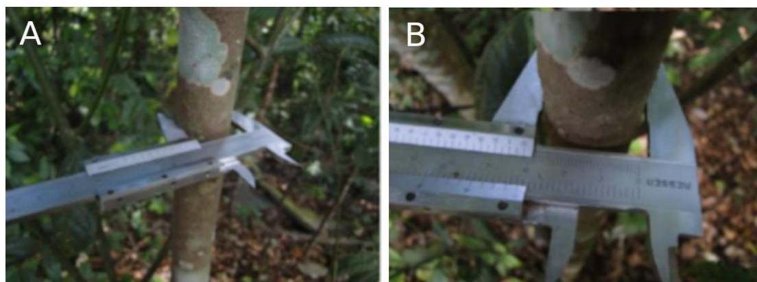
Figura 12 - Como usar o paquímetro para medir o diâmetro em indivíduos com DAP \leq 6 cm. Fotos: Maria Aparecida de Freitas.
