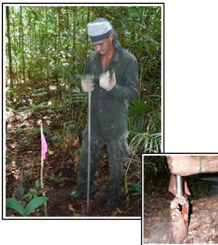
Figura 7 - Perfuração do solo com auxílio do trado manual. No detalhe, base do trado com o solo que foi retirado para a instalação do piezômetro.
