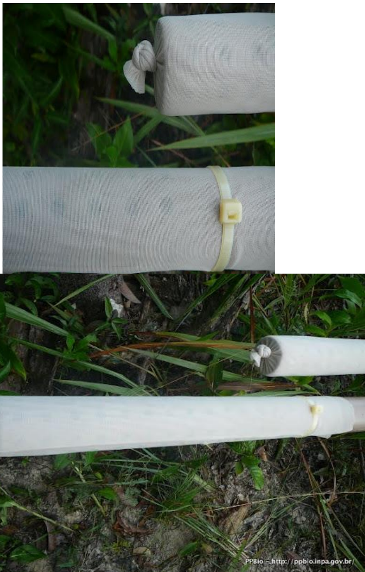
Figura 3. Filtro de um piezômetro envolto em malha e fixado por abraçadeiras plásticas e nó.
