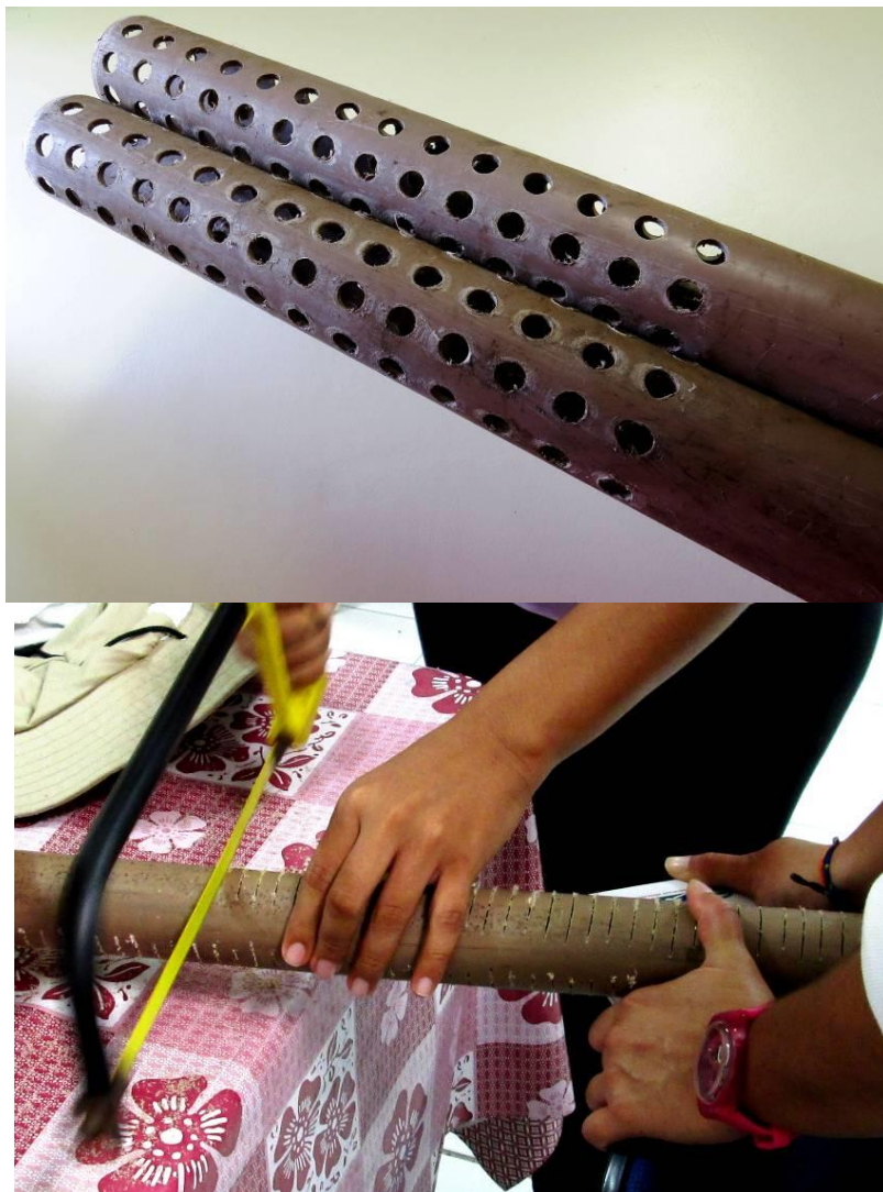
Figura 2. Ranhuras e furos em piezômetros que permitem o fluxo de água. Fotos MAFreitas.
