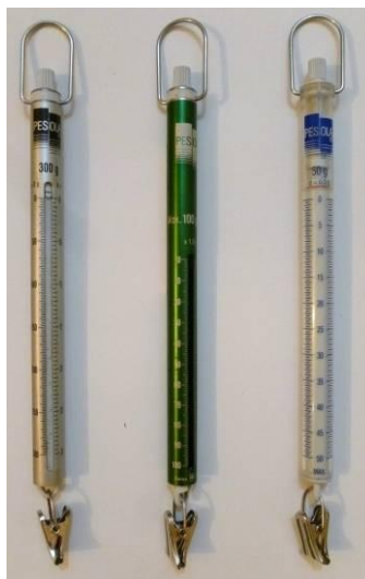
Figura 8. Balanças tipo dinamômetro. Da esquerda para direita, são exemplificadas balanças de 300, 100 e 50 gramas. Foto: Anderson Saldanha Bueno.
