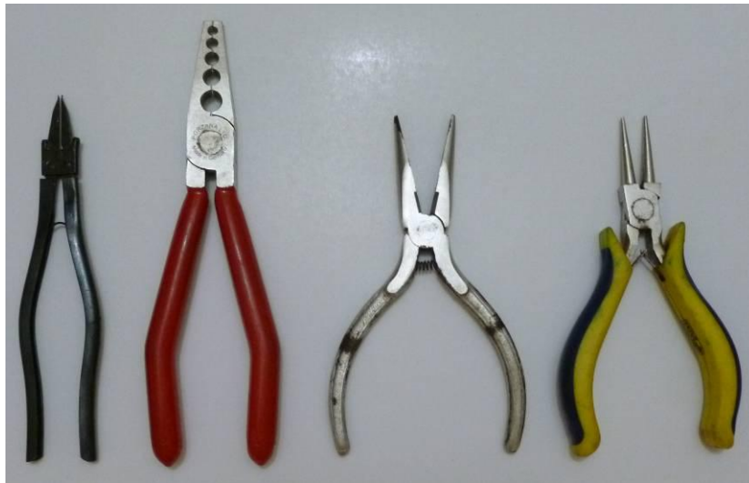
Figura 7. Alicates utilizados para anilhar aves. Da esquerda para direita, são exemplificados alicates utilizados para abrir, fechar e ajustar anilhas e para moldar anilhas de beija-flores. Foto: Anderson Saldanha Bueno.
