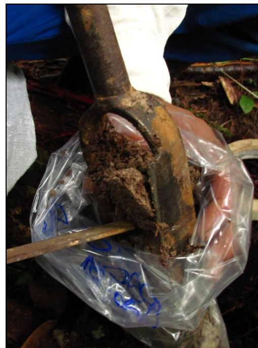
Figura 7 - Para evitar contaminação e interferência nas análises, não coloque as mãos no solo coletado nem apoie o trado sobre o solo.
