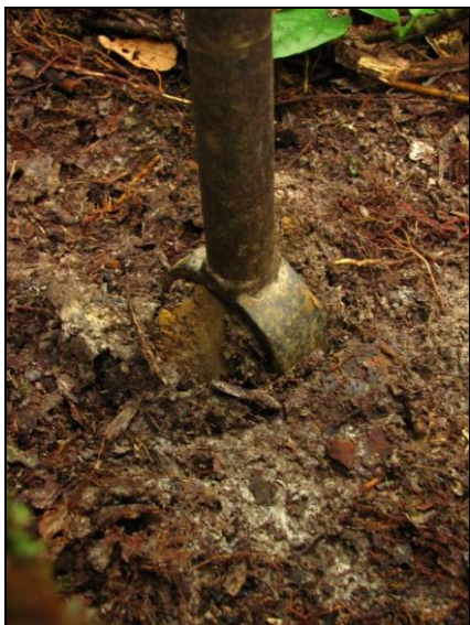
Figura 6 - Ilustração do trado sendo inserido no solo. A serrapilheira foi retirada da área de coleta.
